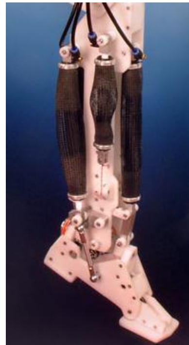
Obrázek 3: Spodní končetina s pneumatickým ovládání pohybu
