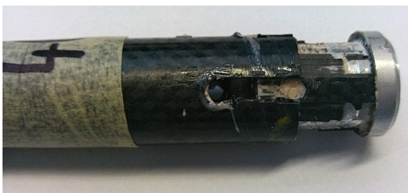
Obrázek 16 - Zatečení lepidla na osazení
