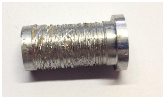
Obrázek 7 - Zdrsnění povrchu soustružnickým nožem
