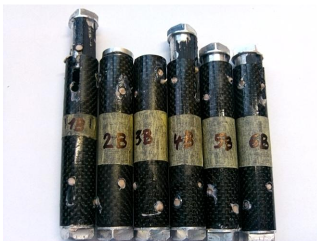
Obrázek 15 - Vzorky typu B po zatěžovací zkoušce
