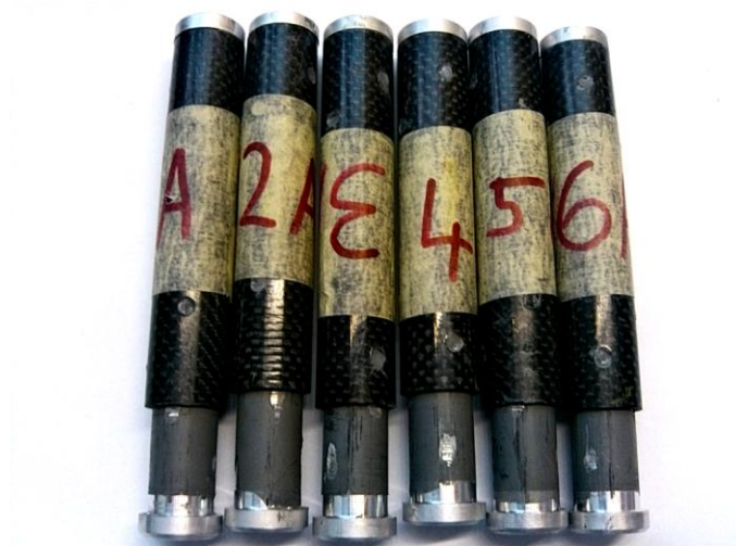
Obrázek 10 - Vzorky typu A po zatěžovací zkoušce
