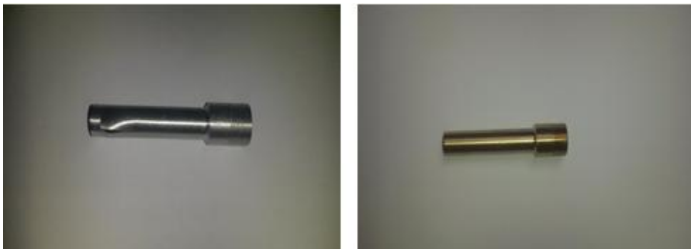
Obrázek 6: Výsledek destruktivní zkoušky u hliníkového a mosazného vzorku
