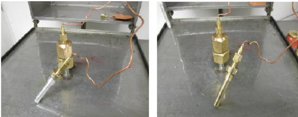
Obrázek 5: Zapojení vzorků z AlMgSi a z CuZn39Pb2 do zkušebního stroje
