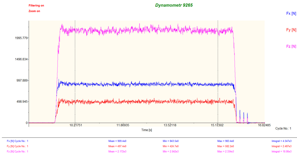
Obr. 55 Zjištění hodnot složek řezných sil pomocí funkce Mean Value v programu Dynoware
