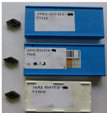
Obr. 42 Úkazka zkoumaných břitových destiček DNMG a DNMX
