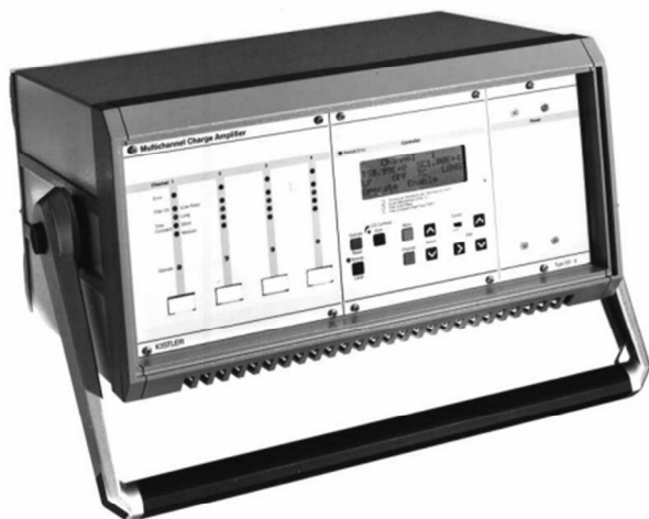
Obr. 40 Technologické parametry zesilovače KISTLER type 5019B
