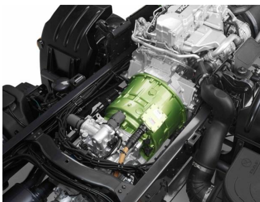
Obr.4-18.: DAF LF Hybrid - elektromotor, prostor mezi spojkou a převodovkou [18]
