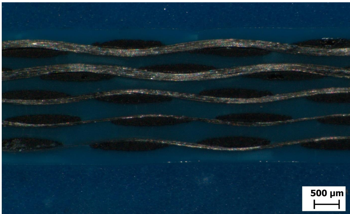
Obrázek 19 - Metalografický výbrus vzorku s ABS matricí
