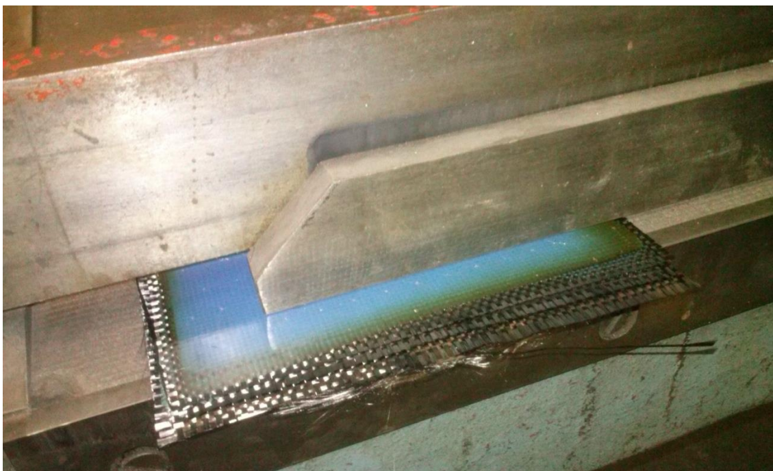
Obrázek 17 - Střihání kompozitových pásků
