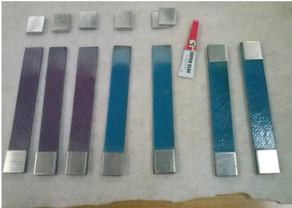
Obrázek 18 - lepení hliníkový příložek
