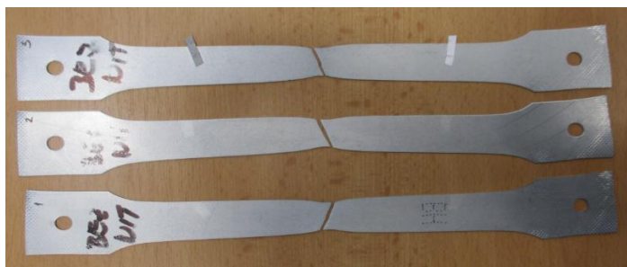
Obr. 19: Vzorčky plechu bez NIT po roztržení
