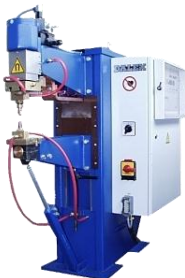
Obr. 20: Svařovací lis Dalex PMS 11-4 [25]
