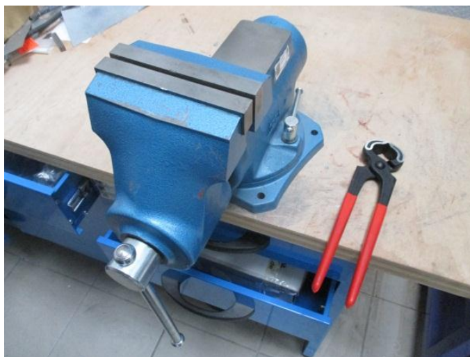
Obr. 22: Svěrák a kleště použité pro odlupovací zkoušku
