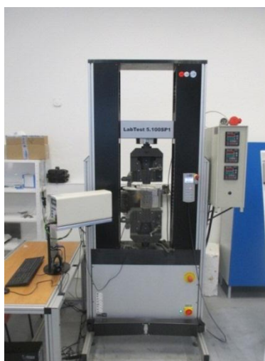
Obr. 17: Zkušební trhací stroj LabTest 5.100SP1
