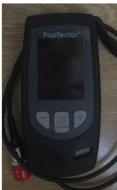
Obr. 16: Zařízení na měření tloušťky povlaku Positector 6000
