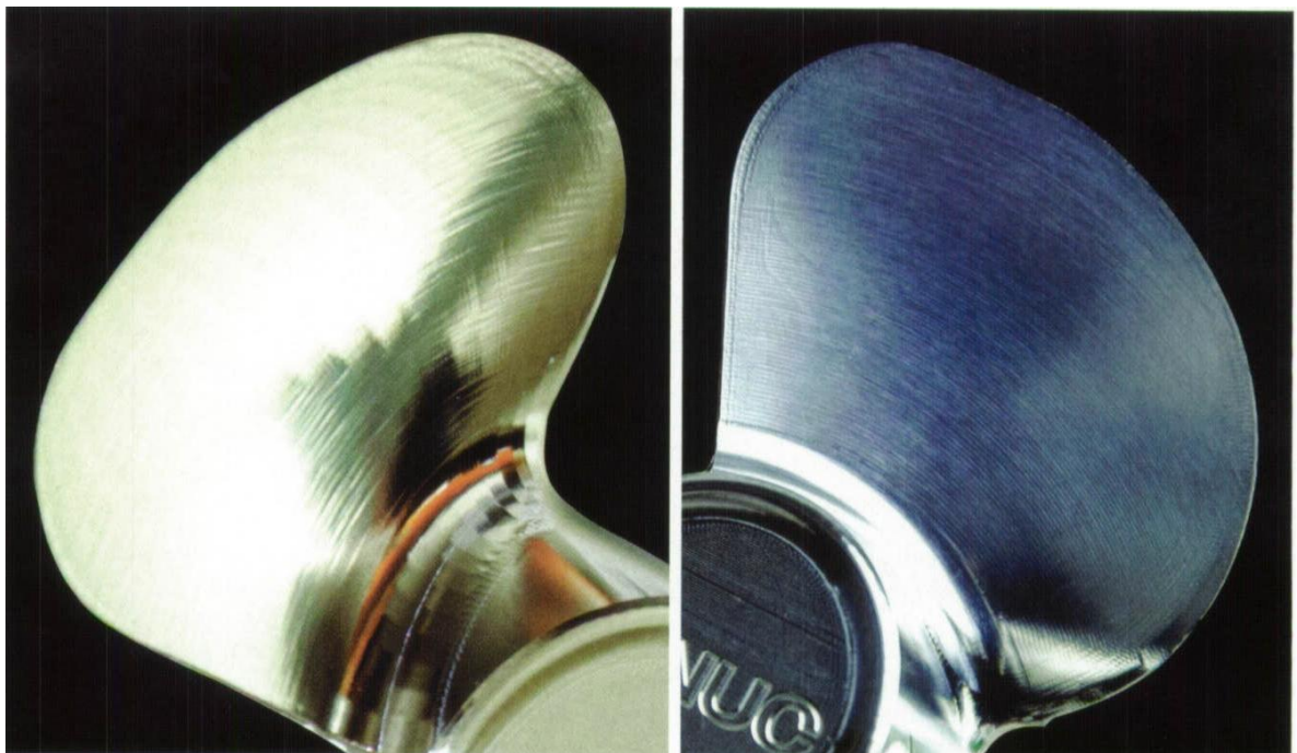
Obr. 13 Porovnání tradičního CNC obrábění (vlevo) a moderního obrábění (vpravo) [8]
