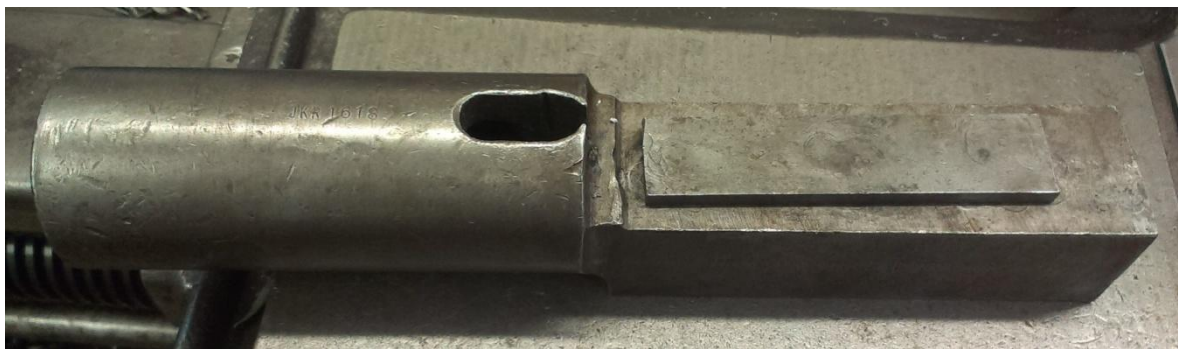
Obr. 4 Speciální držák vrtáku pro upnutí v nožové hlavě
