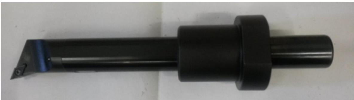
Obr. 15 Nůž pro obrábění otvorů načisto
