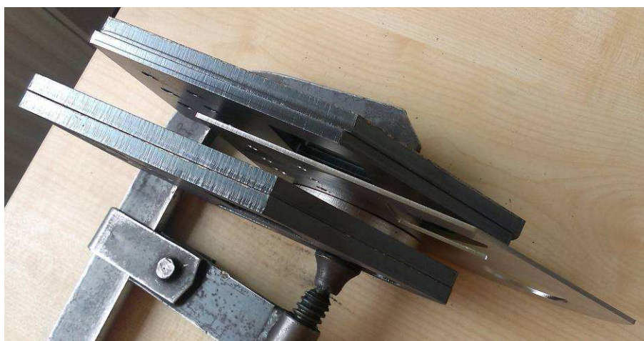
obr. 18 - Improvizovaný přípravek pro měření drsnosti
