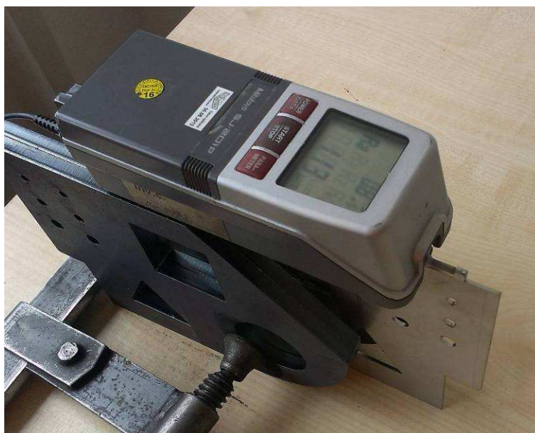
obr. 16 - Měření na druhé straně dílu
