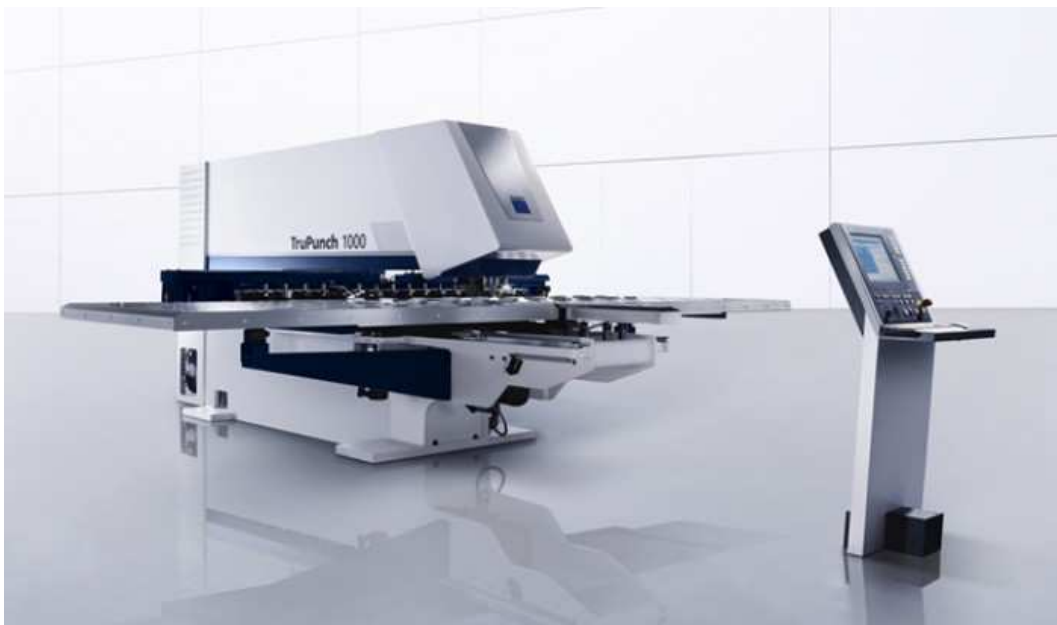
obr. 14 - Vysekávací lis (Trumpf TruPunch 1000) 16
