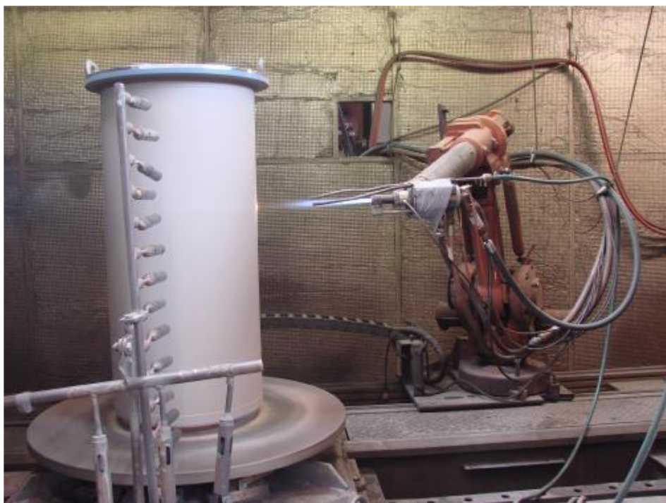
Obr. 4 Nanášení HVOF nástřiku [3, 21]
