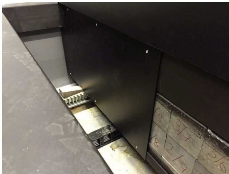
Obr. 34: Částečně zakrytované stínění kanálu
