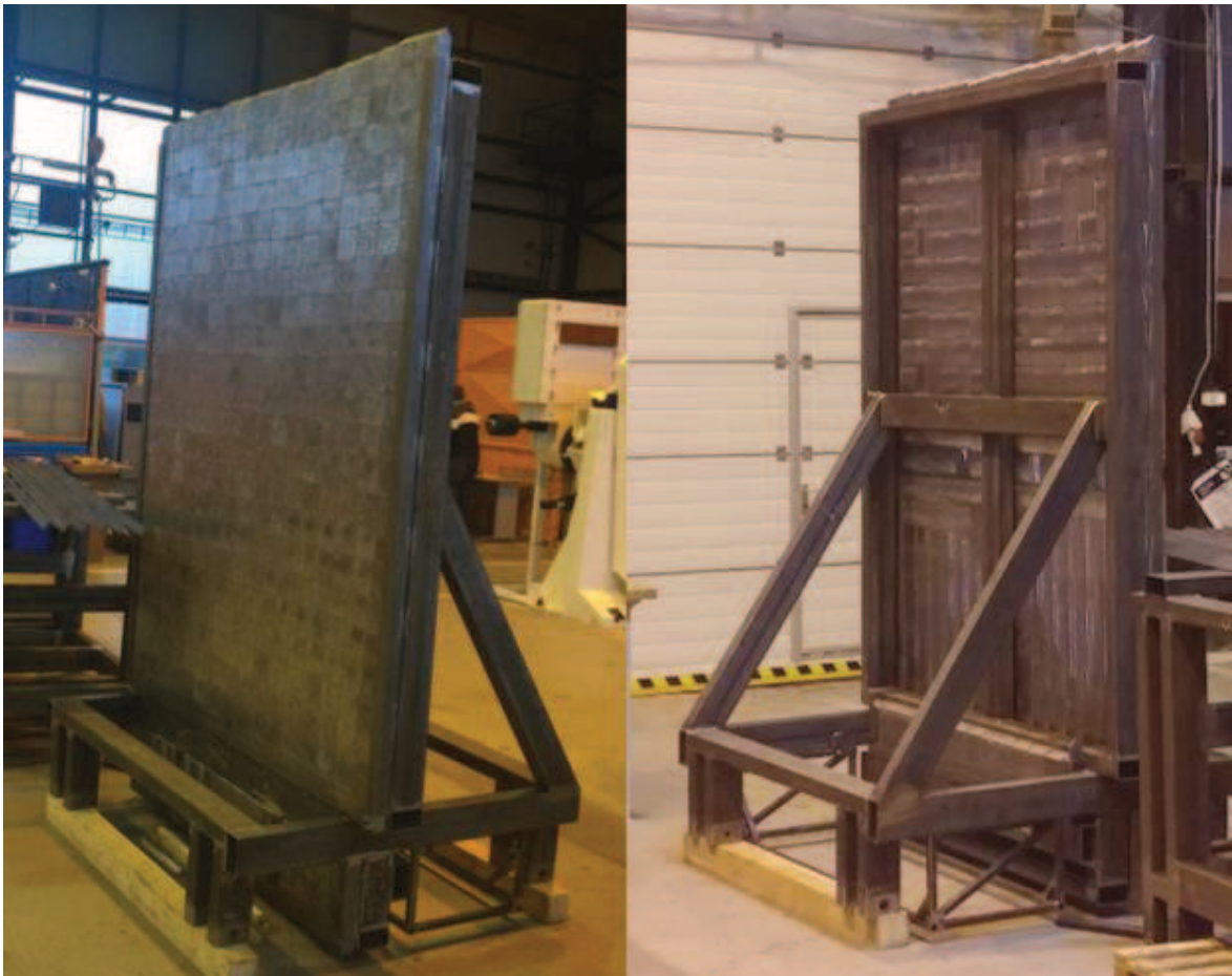
Obr. 29: První zkušební montáž olověných stínících cihel
