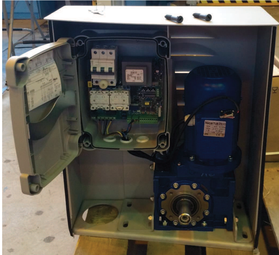
Obr. 30: Pohonná jednotka NICE TUB3500 s integrovanou řídicí jednotkou
