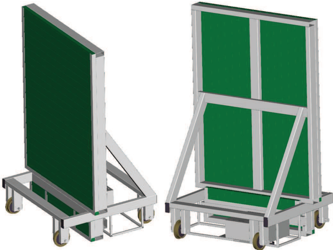
Obr. 11: Čtvrtý (finální) konstrukční návrh bez krytování
