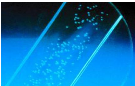
Obr. 12 Drobné bublinky u výstřiku z transparentního polymeru [16]
