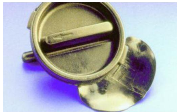
Obr. 5 Přetoky v místě dělicí roviny[16]
