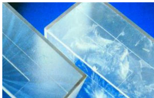
Obr. 11 Stopy po vlhkosti u výstřiku [16]
