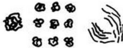
Obr. 2 Nadmolekulární struktura u amorfních polymerů [3]
