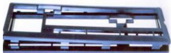
Obr. 8 Průhyb způsobený vyhozením [16]
