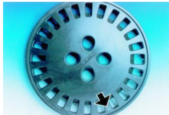
Obr. 7 Stopy po vyhazovači [16]
