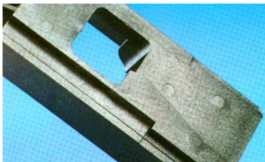
Obr. 15 Studený spoj u polymeru vyztuženého skleněnými vlákny [16]
