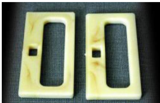
Obr. 10 Tmavé fleky od zdegradovaného materiálu [16]
