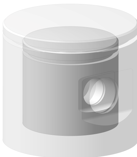
Obr. 7.6 - Rozměrová proměnlivost pístu (rozsah min/max)
