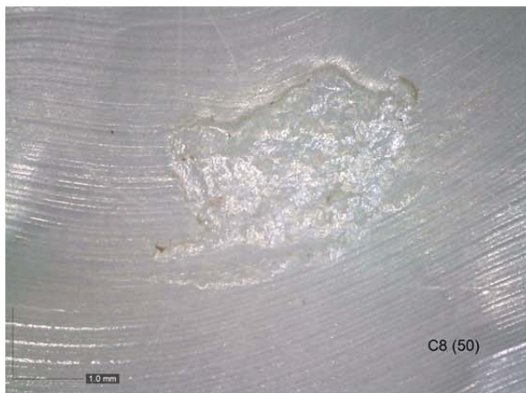
Obr.6.2.12 Opatřebení v oblasti středu osmičky vzorku C8 testovaném s použitím maziva. Vlevo - detail pod mikroskopem Vpravo - detail oblasti z 3D skeneru
