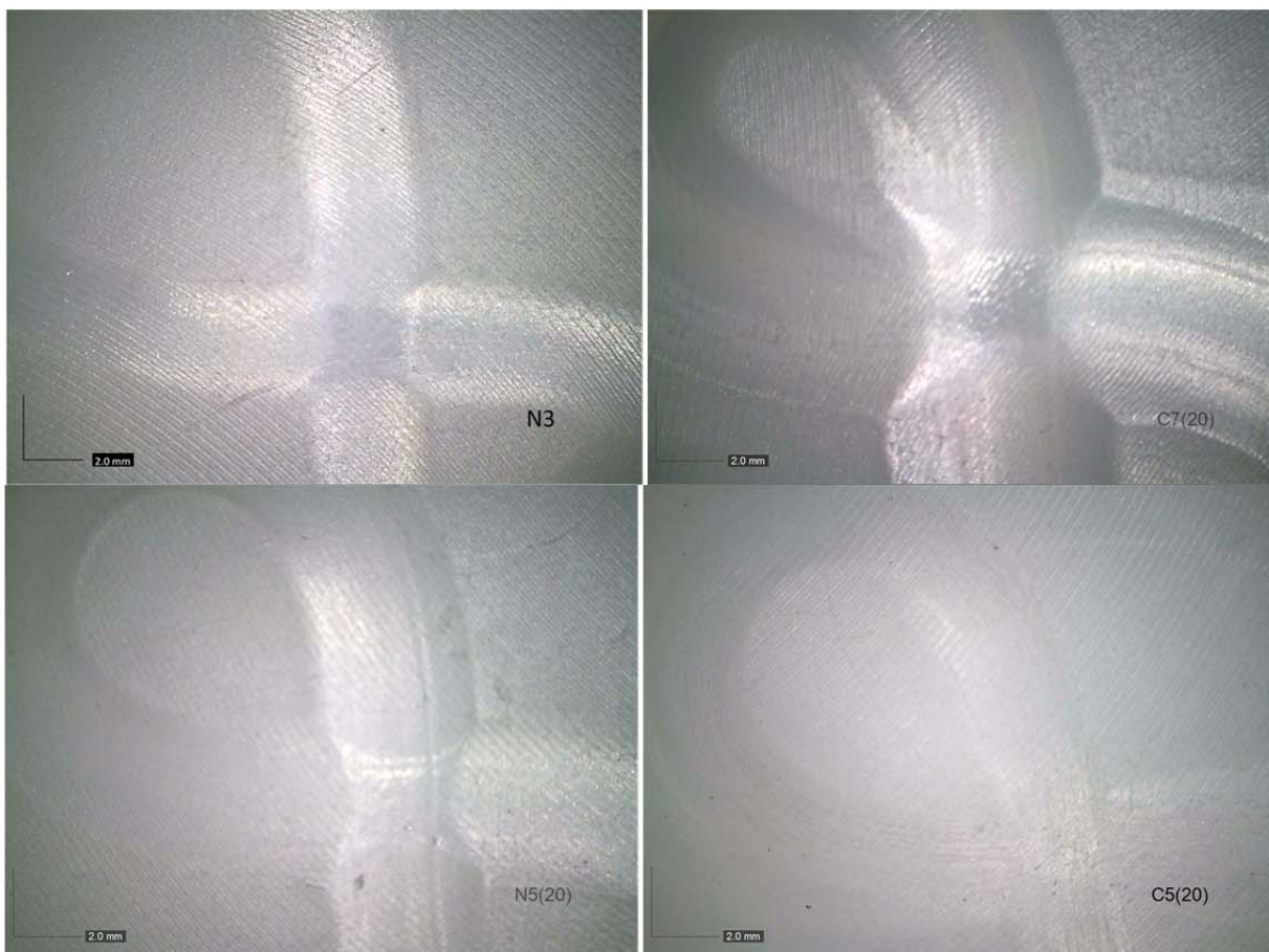
Obr6.2.11 Tvar otěrové drážky při 50N, 100N, 213N a 500N
