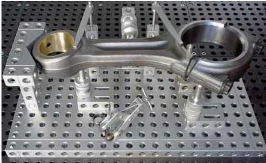
Obr. 25 Upnutí ojnice klikového mechanismu [23]
