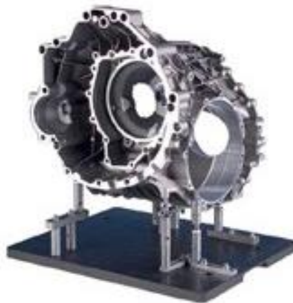
Obr. 17 Upínací stavebnice s rastrovou deskou [18]
