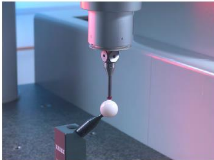
Obr. 12 Kalibrace snímacího doteku [8]
