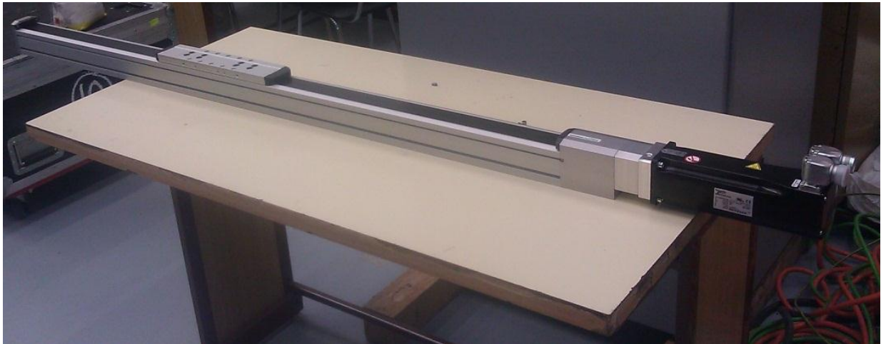
Obrázek 30 - lineární vedení s vozíkem a servomotorem [8]
