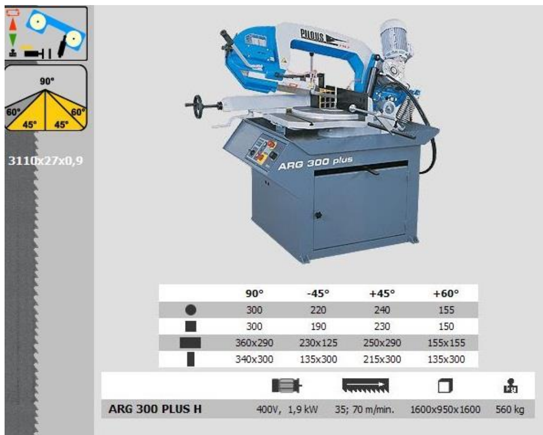
Obrázek 4.3.1.2 Technické parametry Pilous ARG 300 plus
