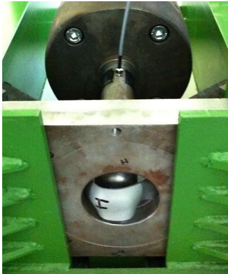
Obrázek 69: Zkušební vzorek v přidržovači po provedení zkoušky (úhel 36°)
