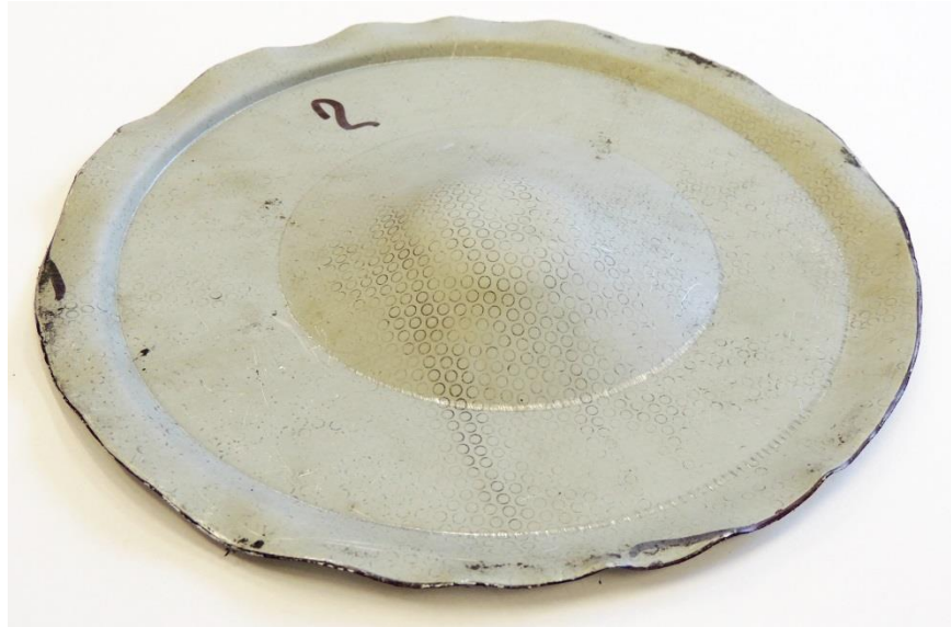
Obrázek 49: Zkušební vzorek po provedení měření č. 2, materiál DC06
