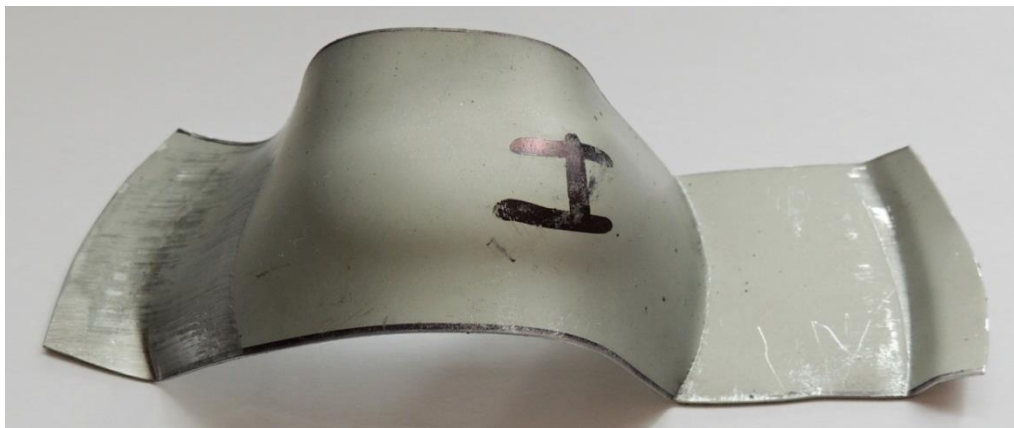
Obrázek 68: Zkušební vzorek po provedení zkoušky (úhel 36°)
