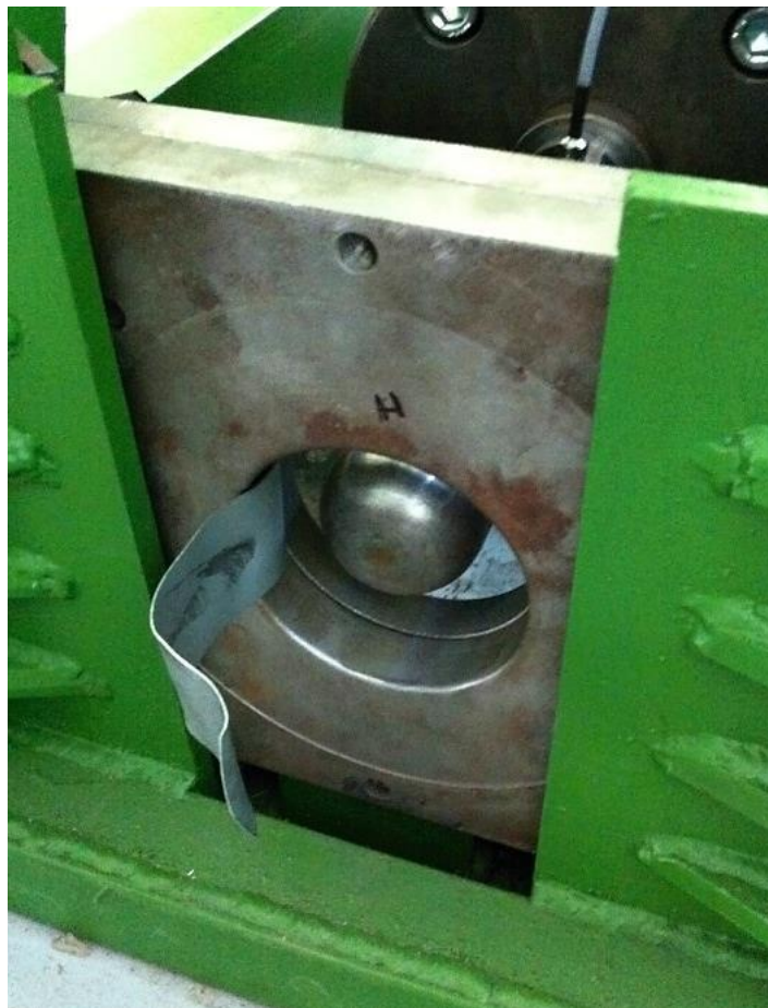
Obrázek 66: Uvolněný zkušební vzorek v přidržovači po provedení zkoušky (úhel 34°)
