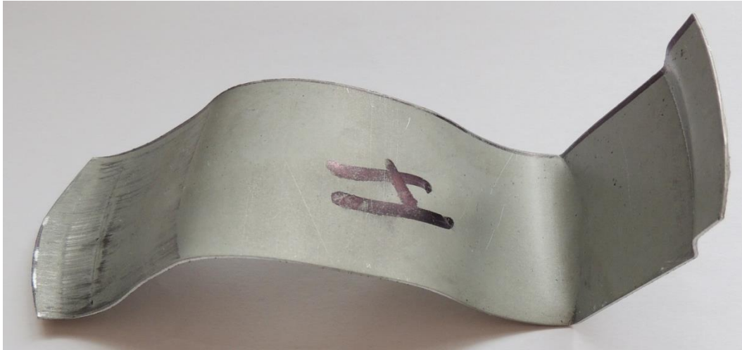
Obrázek 65: Zkušební vzorek po provedení zkoušky (úhel 34°)
