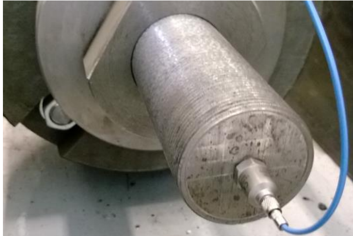
Obrázek 19: Umístění akcelerometru na zadní straně nástroje [15]
