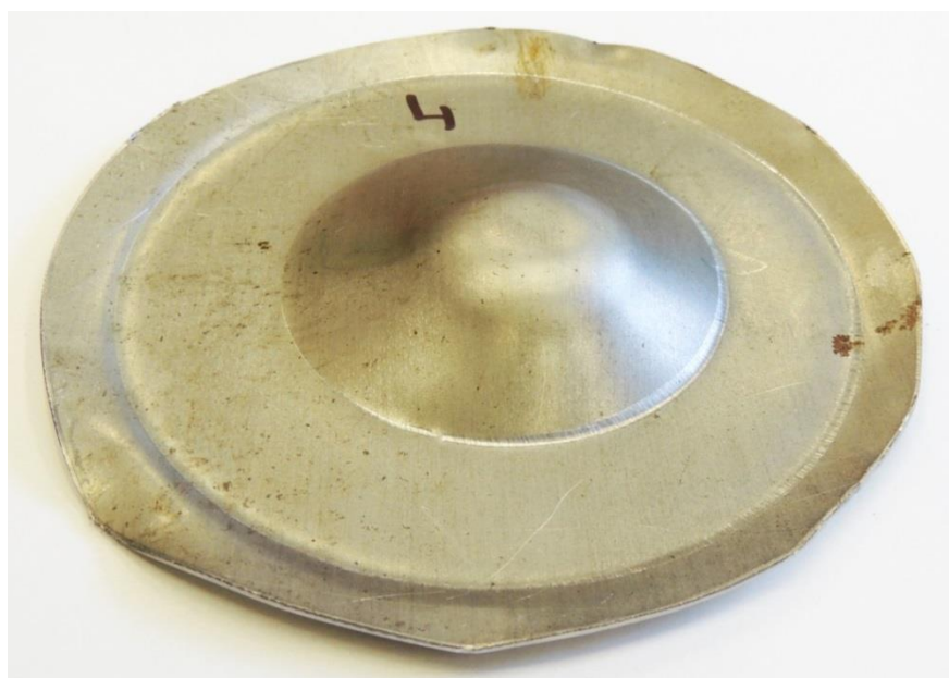
Obrázek 53: Zkušební vzorek po provedení měření č. 4, materiál Docol 1200
