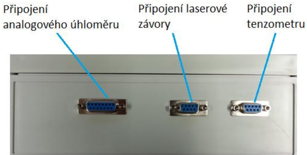
Obrázek 28: Detail panelu s konektory
