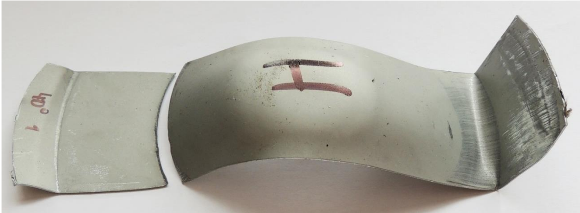
Obrázek 71: Přetržený zkušební vzorek po provedení zkoušky (úhel 42°)
