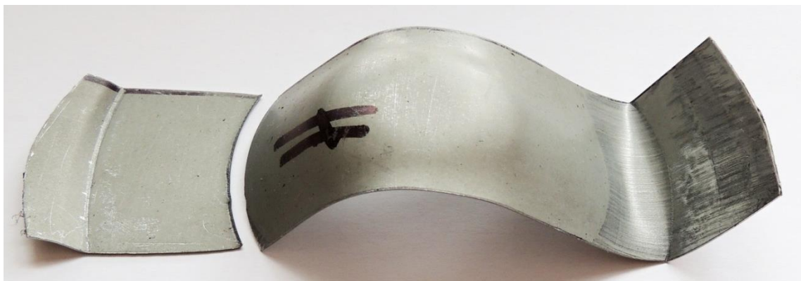
Obrázek 74: Přetržený zkušební vzorek po provedení zkoušky (úhel 44°)
