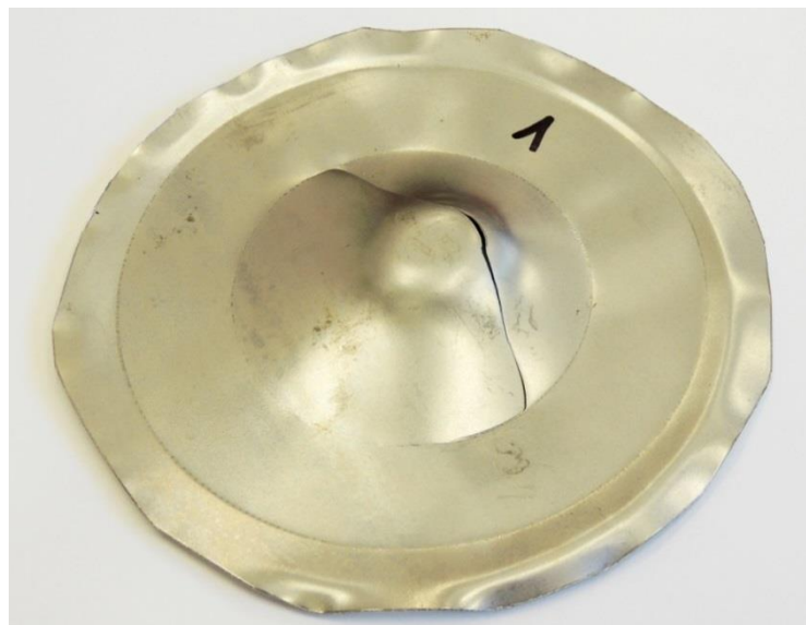
Obrázek 47: Zkušební vzorek po provedení měření č. 1, materiál Docol 1200
