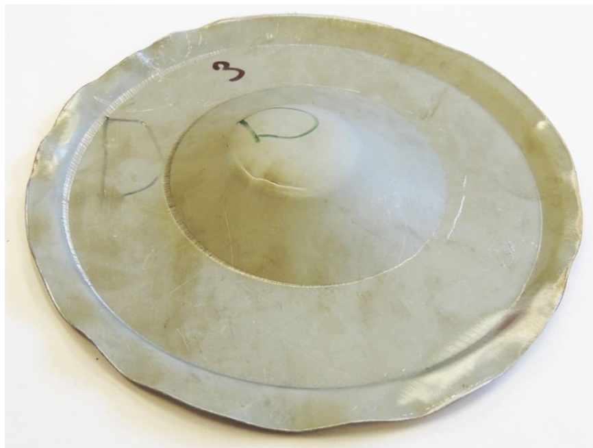
Obrázek 51: Zkušební vzorek po provedení měření č. 3, materiál DC06
