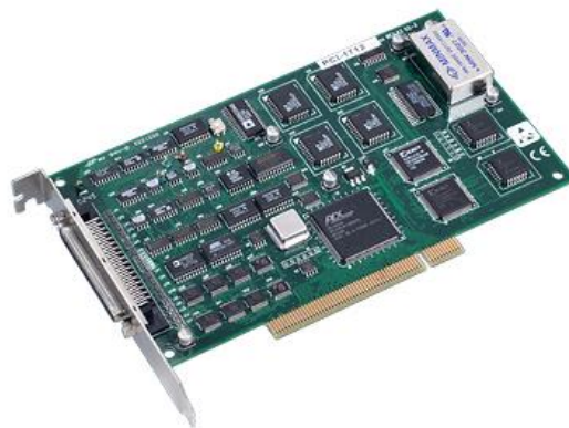
Obrázek 30: Měřicí karta Advantech 1712L-AE [24]
