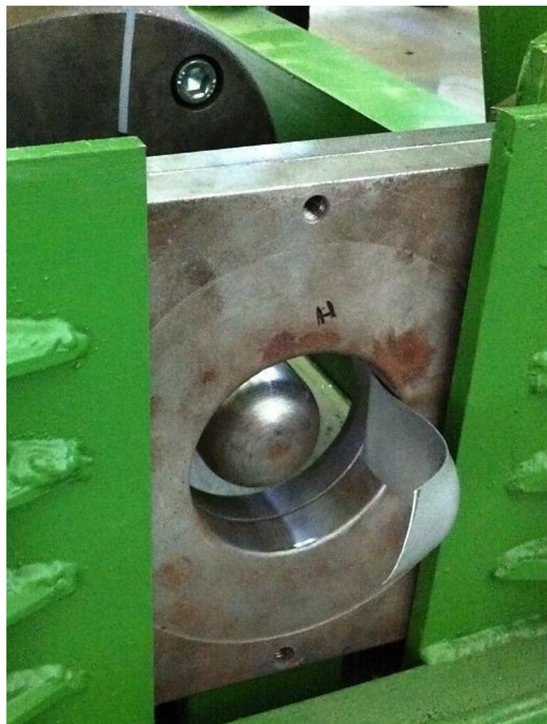
Obrázek 72: Přetržený zkušební vzorek v přidržovači po provedení zkoušky (úhel 42°)
