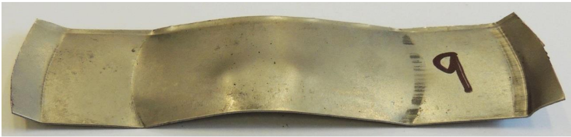
Obrázek 63: Zkušební vzorek po provedení měření č. 9, materiál Docol 1200
