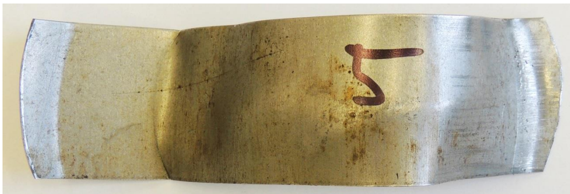
Obrázek 55: Zkušební vzorek po provedení měření č. 5, materiál Docol 1200
