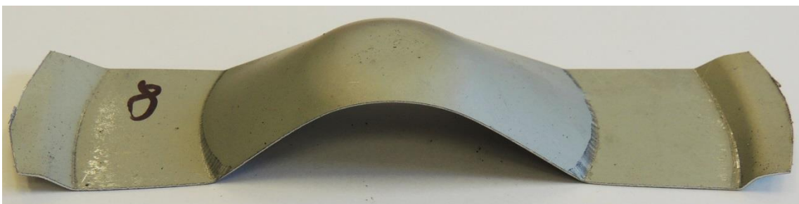
Obrázek 61: Zkušební vzorek po provedení měření č. 8, materiál DC06
