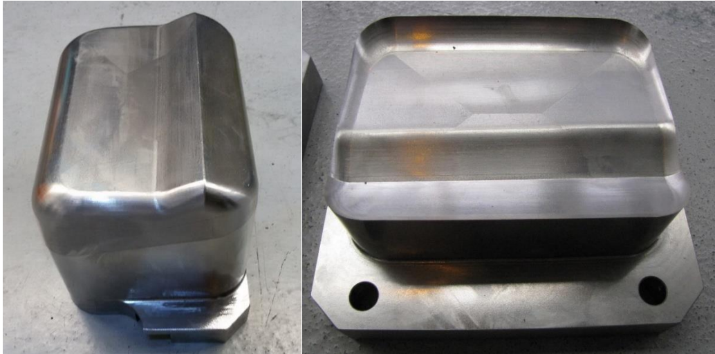
Obr. 32 Fotografie reálného nástroje (vlevo - tažník, vpravo – tažnice ) [30]
