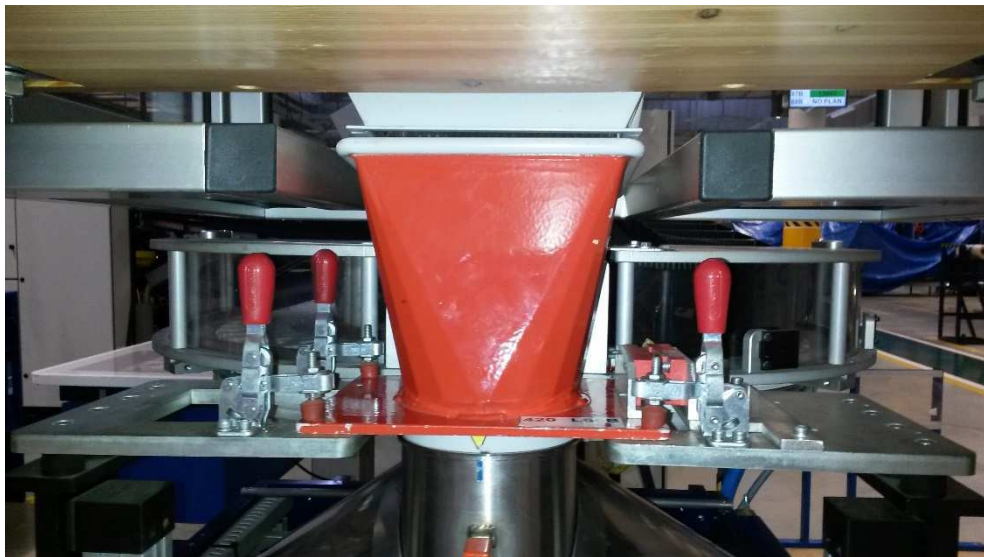
Obr. 6 – 1: Pohled na umístění trychtýře v balicím zařízení
