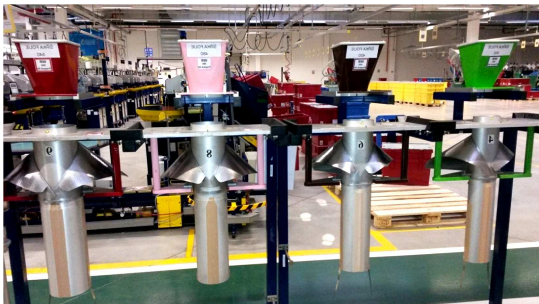
Obr. 2 – 10: Trychtýře s tubusy pro linku Prepack 99
