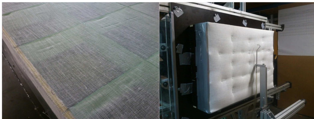
Obr. 19: Proměření rychlostního profilu clony
