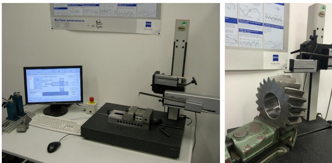
Obrázek 27: Měřicí zařízení drsnosti povrchu a ukázka měření drsnosti povrchu hlavové kružnice
