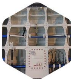
Obrázek 46: Kostra dveří letadla Dassault Falcon F7X [26]
