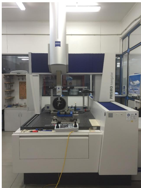
Obrázek 56: CMM Prismo Navigator v Latecoeru
