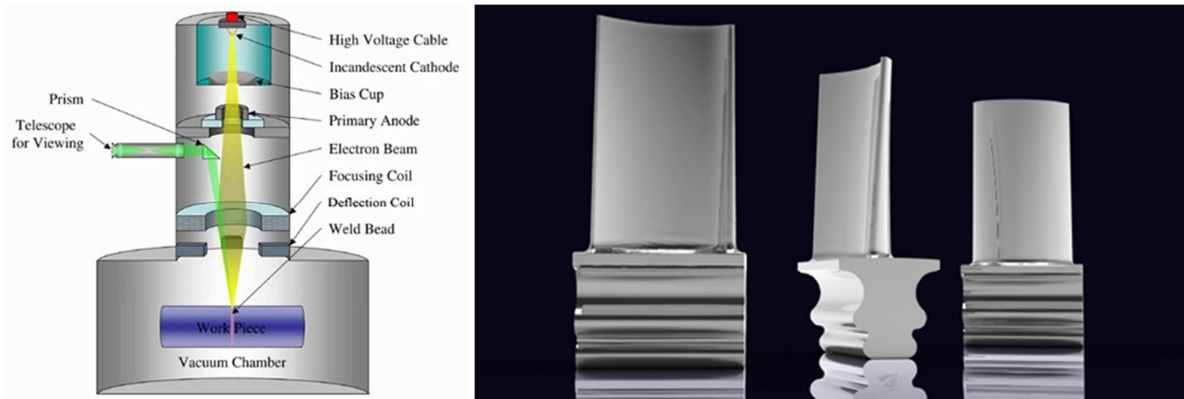
Obrázek 10 – princip technologie EBM + ukázka lopatek vyrobených touto technologií [9][23]
