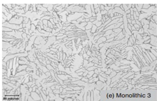
Obrázek 15 – ukázka rozdílných struktur při použití různých technologií zpracování[14]
