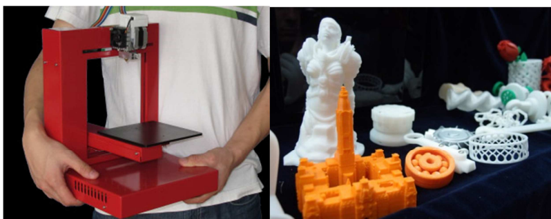
Obrázek 1- Stolní tiskárna pro tisk maloformátových plastových výrobků + ukázka možných výrobků
