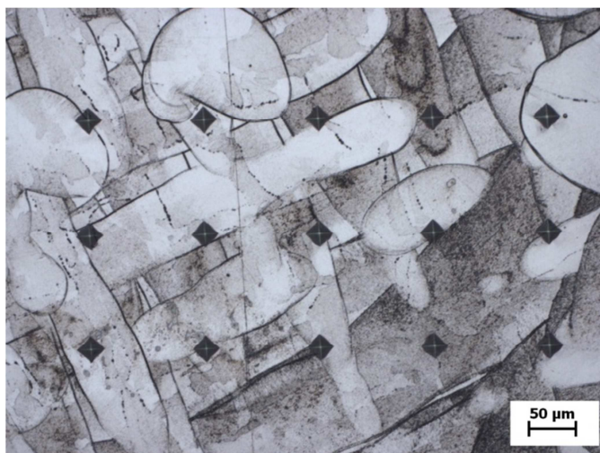
Obrázek 40 – detail vpichů, zatěž. síla 100g – zvětšení 100x
