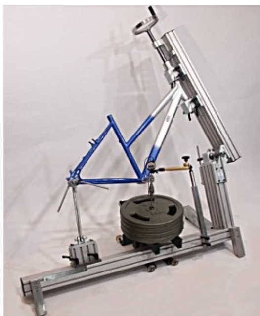
Obrázek 3.8: Měření Out-of-saddle rigidity
