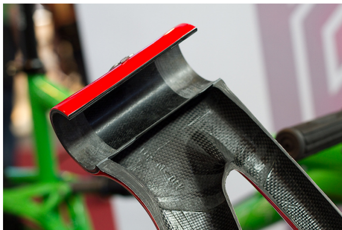
Obrázek 3.9: Řez rámem Santa Cruz carbon V10 www.pinkbike.com
