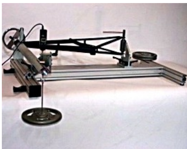
Obrázek 3.7: Měření Track holding rigidity
