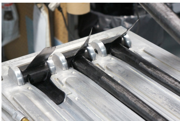
Obrázek 3.10: Forma s naskládaným prepregem [8]
