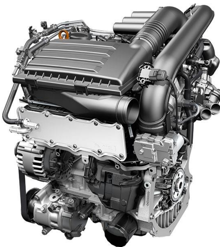
Obr. 3 Čtyřválcový blok motoru o objemu 1,4 l TSI [5]
