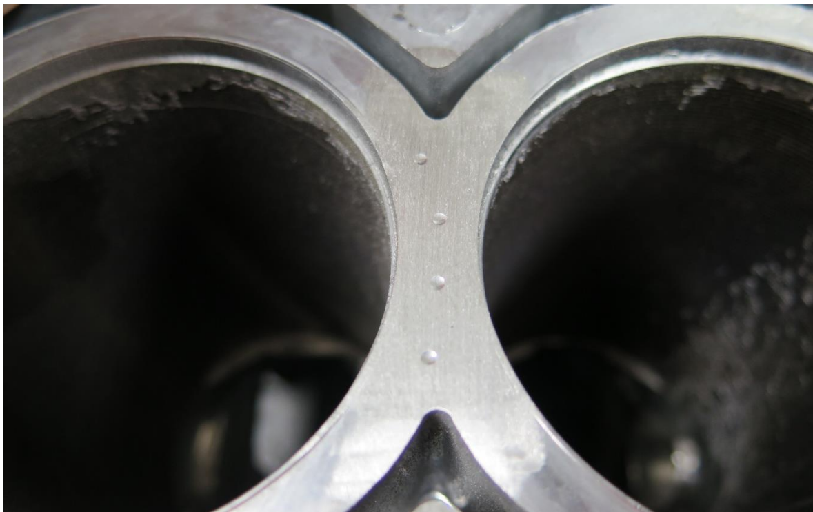
Obr. 39 Měřené vpichy v oblasti můstku mezi válci- měření po odlití a žíhání[3]
