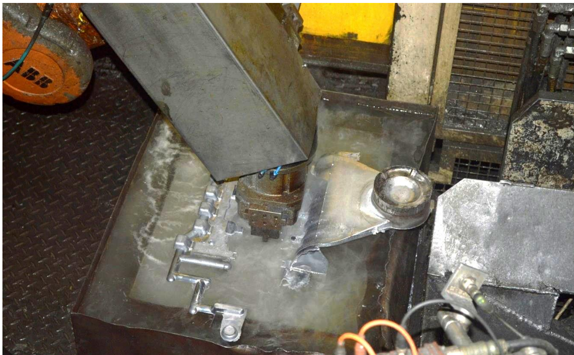
Obr. 35 Snímek při zachlazování odlitku ve vodní lázni [3]
