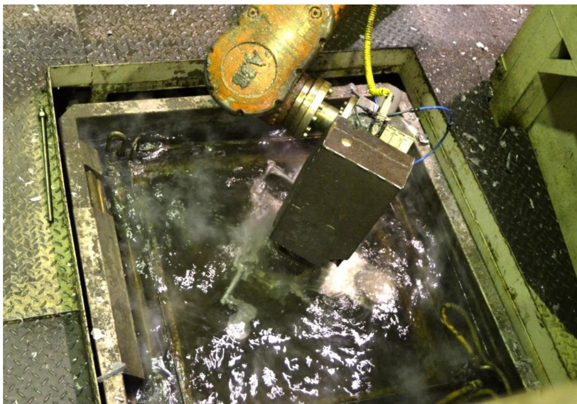
Obr. 38 Zachlazování tříválcového bloku motoru 1,0 l TSI [3]
