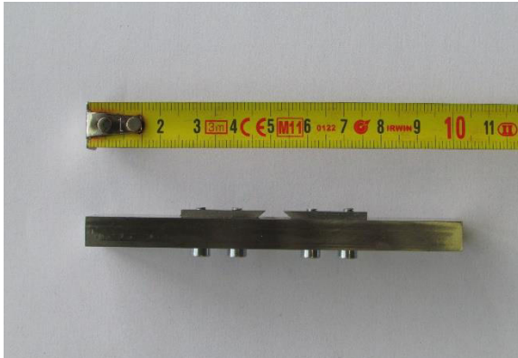
obr. 30 – zkušební těleso s přípravky pro upevnění extenzometru, [autor]
