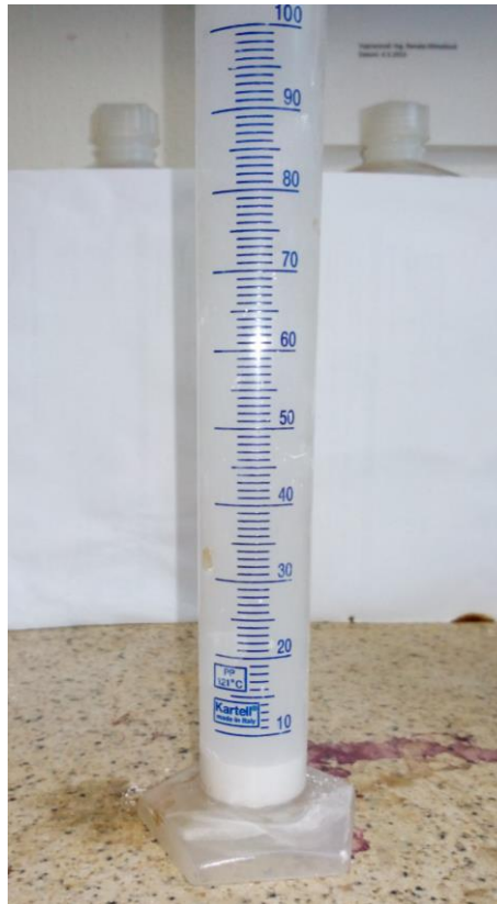
Obr. 34 Odměrný válec pro orientační vizuální zkoušku usazení částic.
