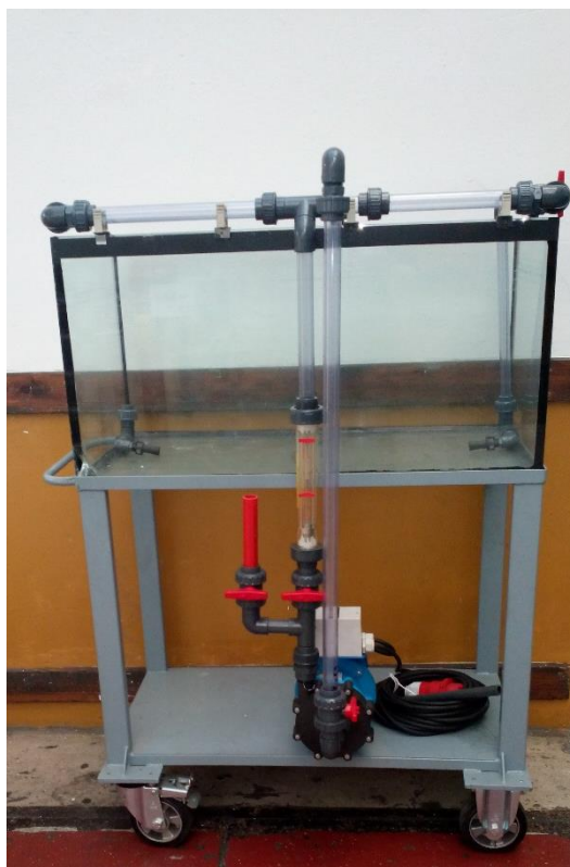
Obr. 31 Experimentální zařízení pro vizualizaci procesu míchání pomocí ejektoru.
