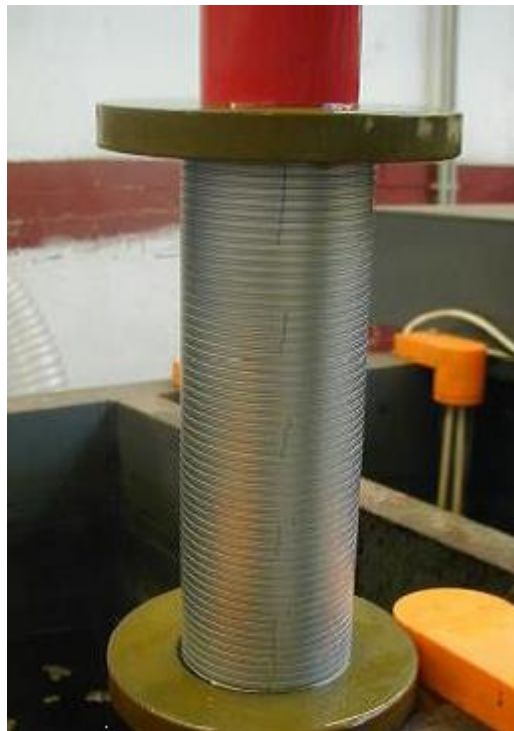
Obr. 23 Chromovací trn s pístními kroužky (Buzuluk)
