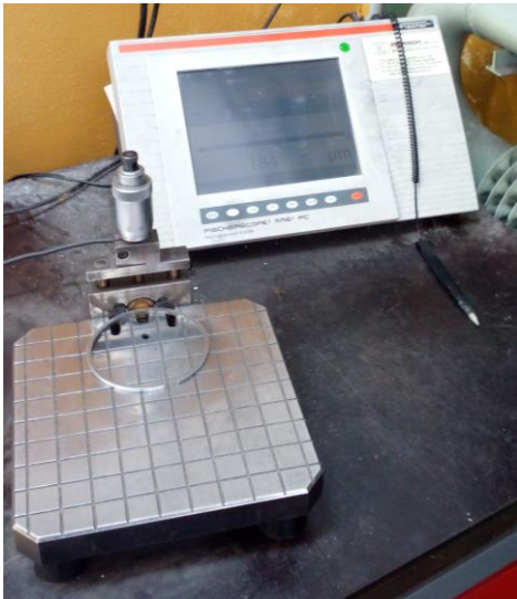
Obr. 41 FISHERSCOPE MMS PC – měření tloušťky Cr povlaku na pístních kroužcích ve firmě Buzuluk.
