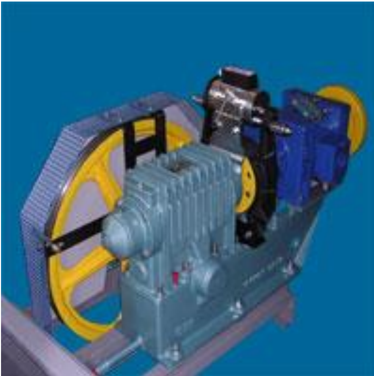
(Obr. 2.6.: Výtahový stroj S3 – 320 firmy Wykov[11])
