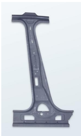
Obr. 14 Nejběžnější použití B-sloupek tloušťka 1,85mm (8)
