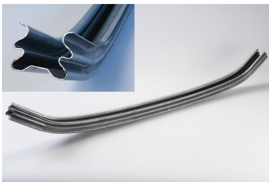
Obr. 12 Příčný nosník nárazníku z materiálu TRIP 780 (tloušťka 1,6 mm) [8]
