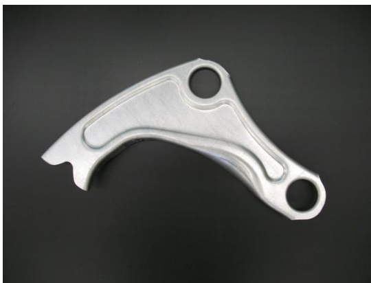
Obr. 10 závěsné rameno z materiálu Complex Phase 800 (tloušťka 3,1 mm) [8]
