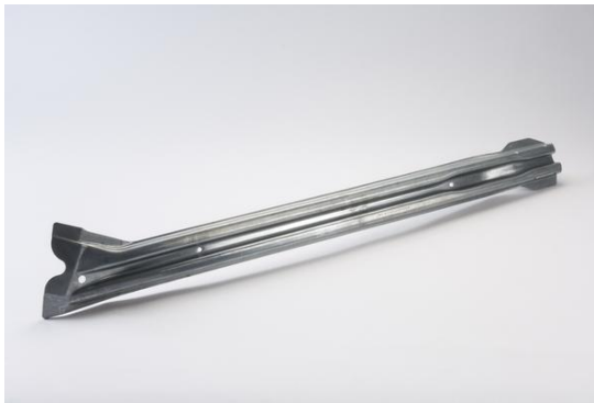
Obr. 9 Výztuha bočních dveří z materiálu Complex Phase 1000 (tloušťka 2 mm) [8]
