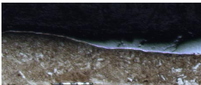
Obr. 43 Vzorek 9K povrchová vrstva v místě kontaktu s elektrodou
