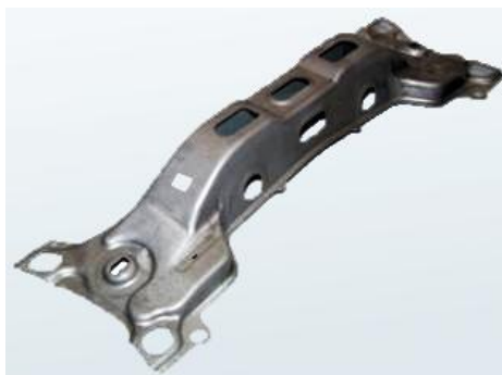
Obr. 2 zádňi přičník z materiálu Extragal®-coated HSLA 300 [8]
