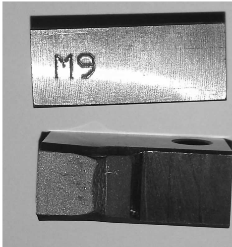
Obr. 16 Vzorek M9 po testu a dolomení
