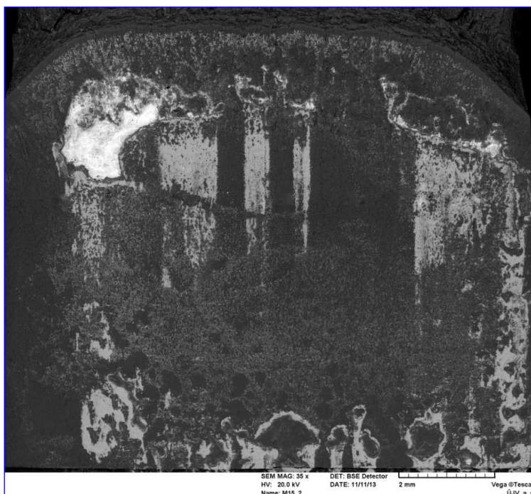
Obr. 12 Fotografie povrchu lomu s viditelnými zbytky olova na povrchu (světlé skvrny)
