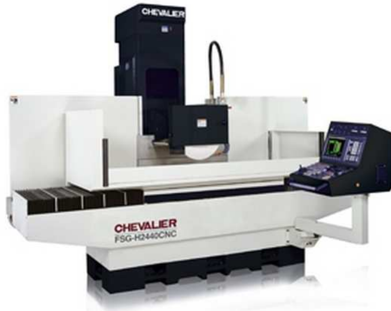
Obr. 3-7: Bruska FSG-H/B 2460 CNC [7]
