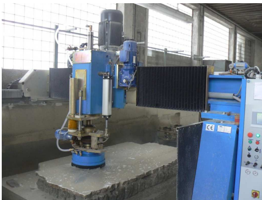
Obr. 3-6: Bruska SPA 14/41 HP W K na broušení desek [4]
