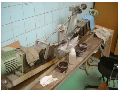
Obr. 4-4: Zařízení s rotujícími formami [2]
