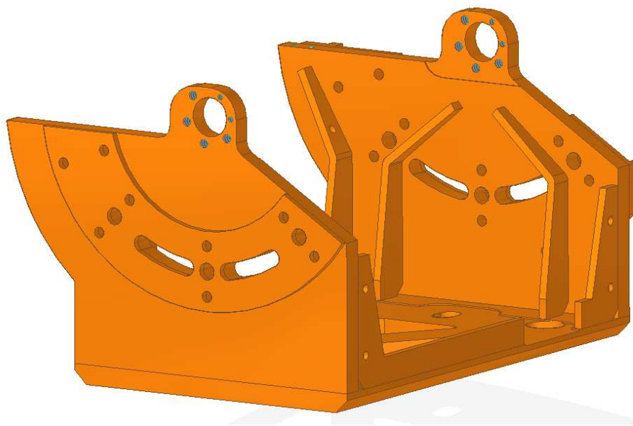
Obr. 7-7: Úhlové drážky v kolébce
