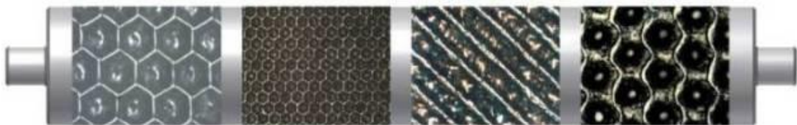
obr. 7 Mikroskopické zvětšení jamek rastrového válce
