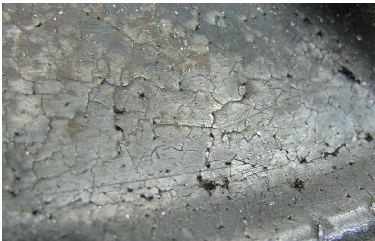
Obr. 13 Detail trhlinek na pevné vložce
