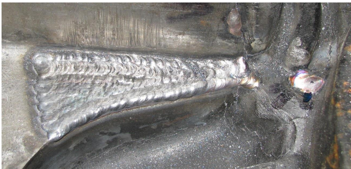
Obr. 18 Vyvaření dělicí roviny a vymleté části vložky
