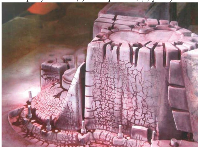
Obr. 11 Příklad tepelných trhlin (a) detail povrchu, (b) příčný řez – leštěno [13]
