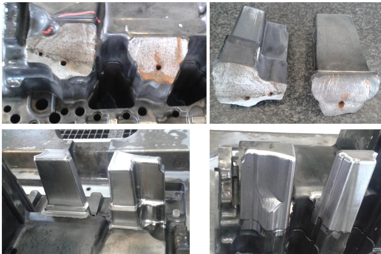
Obr. 14 Proces opravy - navaření dvou sloupků
