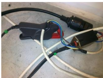
Obr. 9 - Měření na fázi kabelového přívodu
