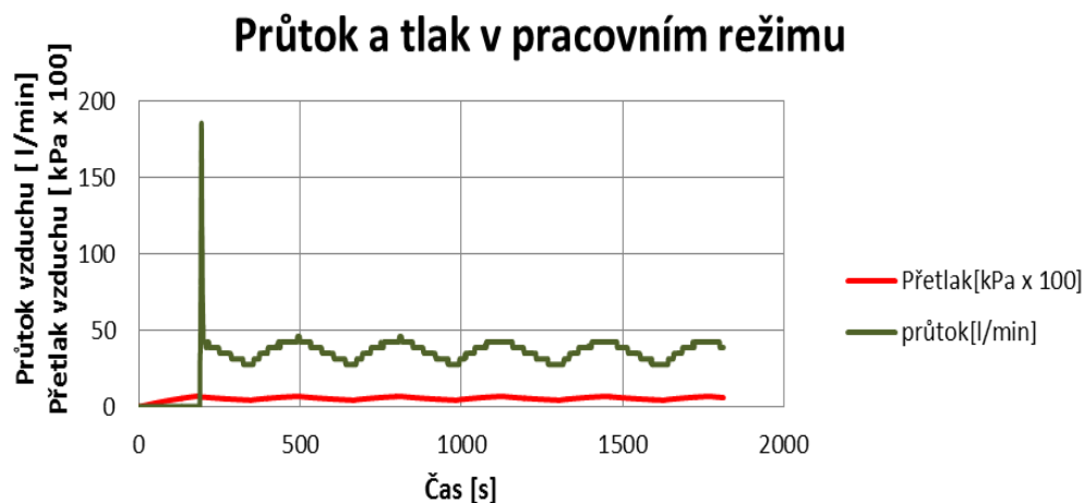
Obr. 15 - Průtok a tlak v pracovním režimu
