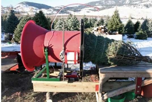
obr. 6.: Balící stroje s pracovním pohybem přímočarým a rotací kolem stromku (zdroj: [7])
