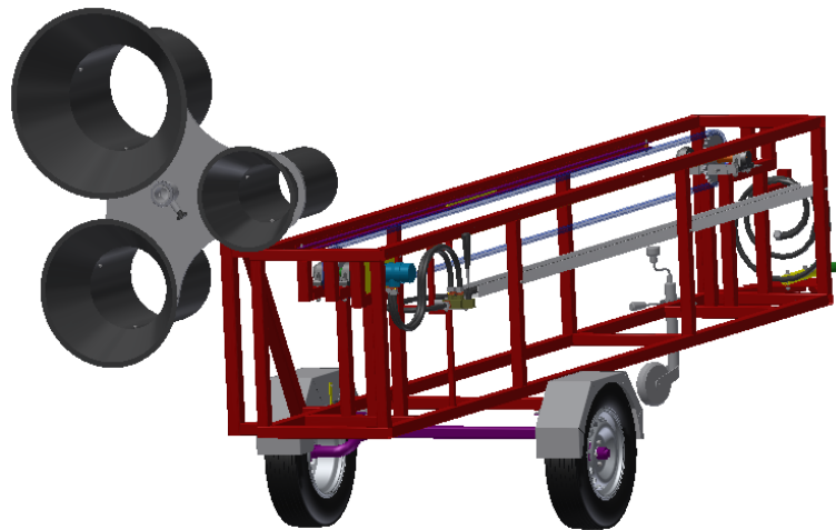
obr. 38.: Rotační mechanismus polohovače balících kornoutů (zdroj: autor)
