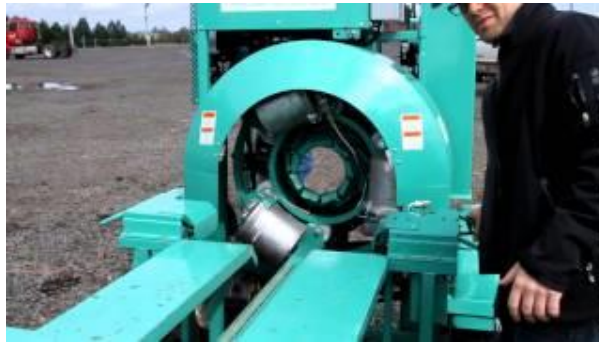
obr. 7.: Rotační hlavice pro balení stromku (zdroj: [8])
