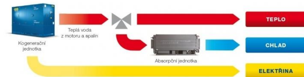
Obrázek 3: Toky energií v procesu trigenerace [6]
