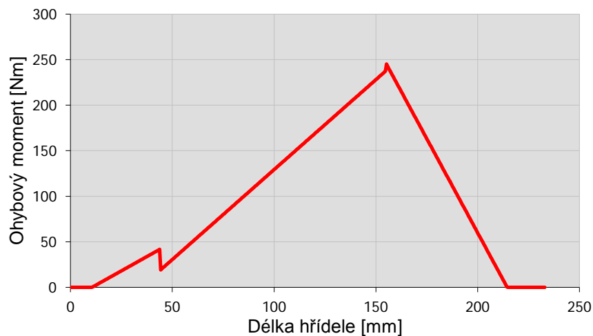
Obr. 12.: Průběh ohybového momentu pro smysl otáčení „1“
