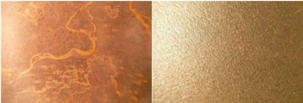
Obrázek 4.9: Otryskaný povrch před a po aplikaci SM 140 [19]
