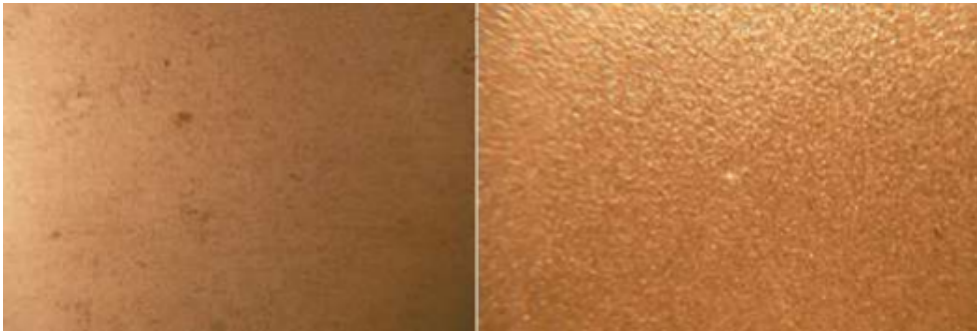
Obrázek 4.8: Otryskaný povrch před a po aplikaci S 330 [19]
