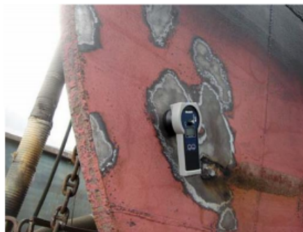
Obrázek 2.10: Aplikace přístroje Hedon SSM [4]
