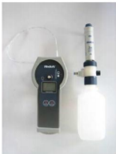
Obrázek 2.9: Přístroj pro měření obsahu solí Hedon SSM [4]
