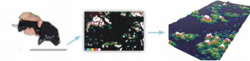
Obrázek 2.11: Postup vyhodnocení mastnoty na povrchu přístrojem Recognoil [10]
