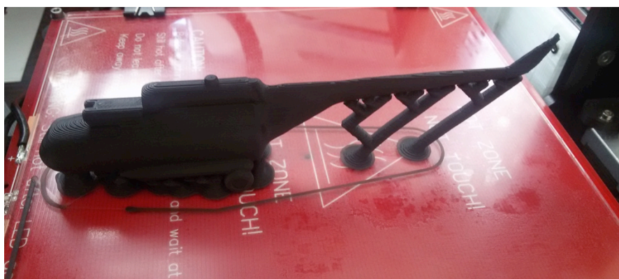
Obrázek 4.20: Dokončení tisku trupu helikoptéry
