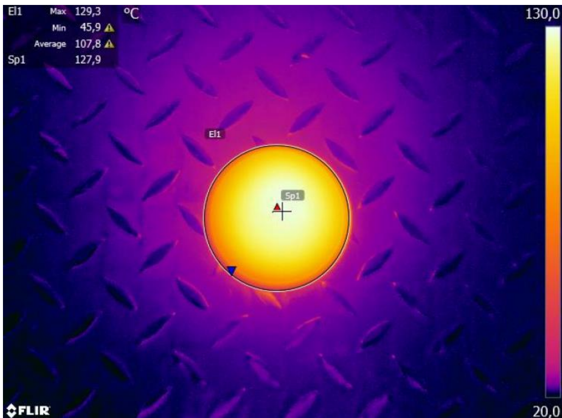
Obrázek 7.2: Snímek puku z termokamery po 4 minutách
