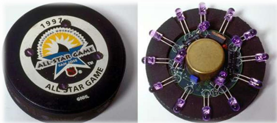
Obrázek 2.1: Hokejový puk FoxTrax s kruhovým čipem [4]
