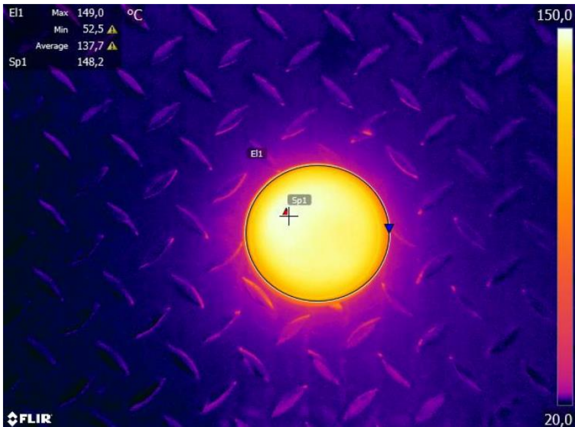
Obrázek 7.1: Snímek puku z termokamery po vyjmutí z bedny
