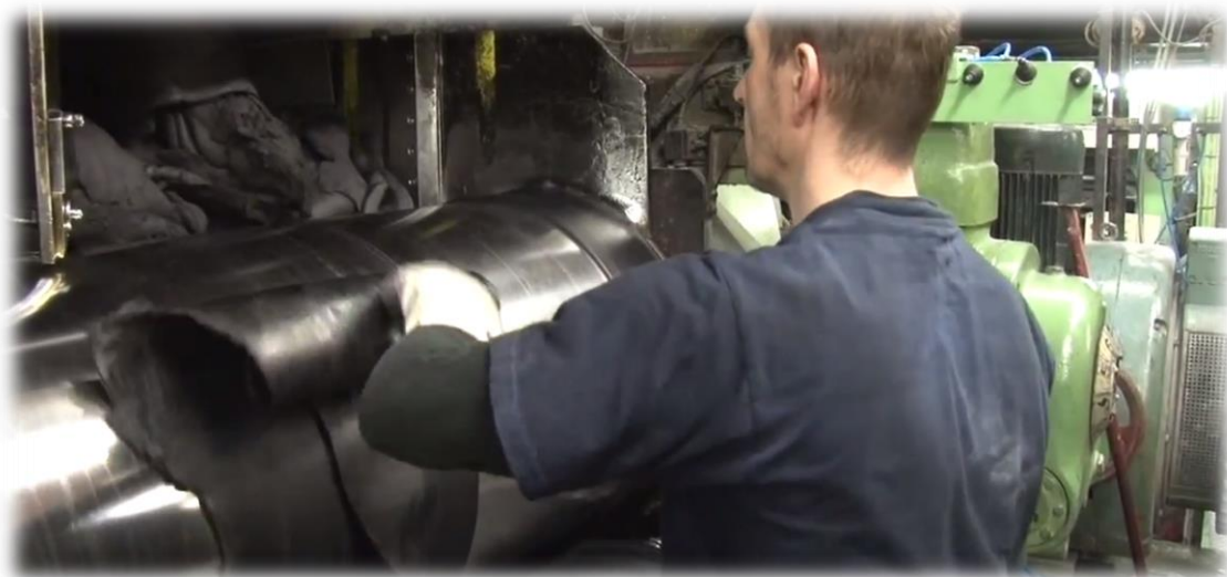
Obrázek 4.3: Míchání a odkrajování směsi na dvouválci
