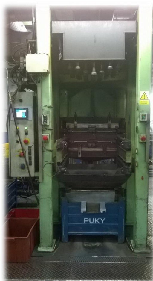
Obrázek 6.2: Tlakový lis určený k vulkanizaci hokejových puků
