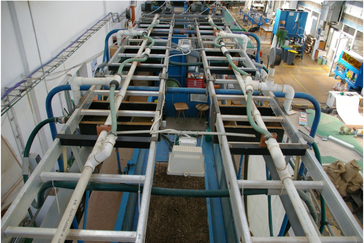
Obr. 4 - Dešťový simulátor na Fakultě stavební ČVUT v Praze [autor]
