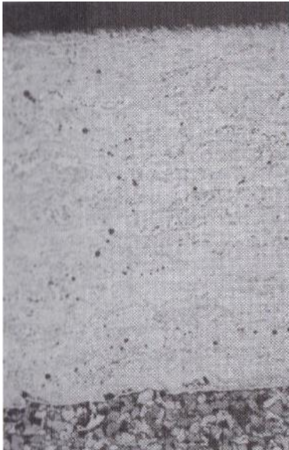
Příloha 8: Nástřik povlaku NiCrBSiC plamenem [3]
