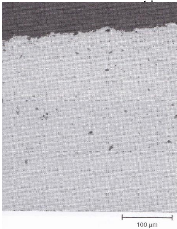
Příloha 11: Povlak WC/Co nanesený vysoko-energickou plazmou [3]
