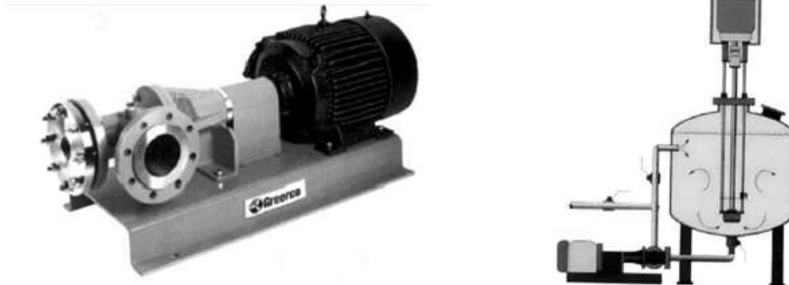
Obrázek 7 - Průtočná míchací zařízení. Vpravo naznačeny cirkulační proudy 1
