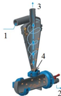
Obr. 14 – Hydrocyklón: 1 – přítok, 2 – odtok těžších částic/nečistot, 3 – odtok čistých lehčích částic, 4 - dýza [27]
