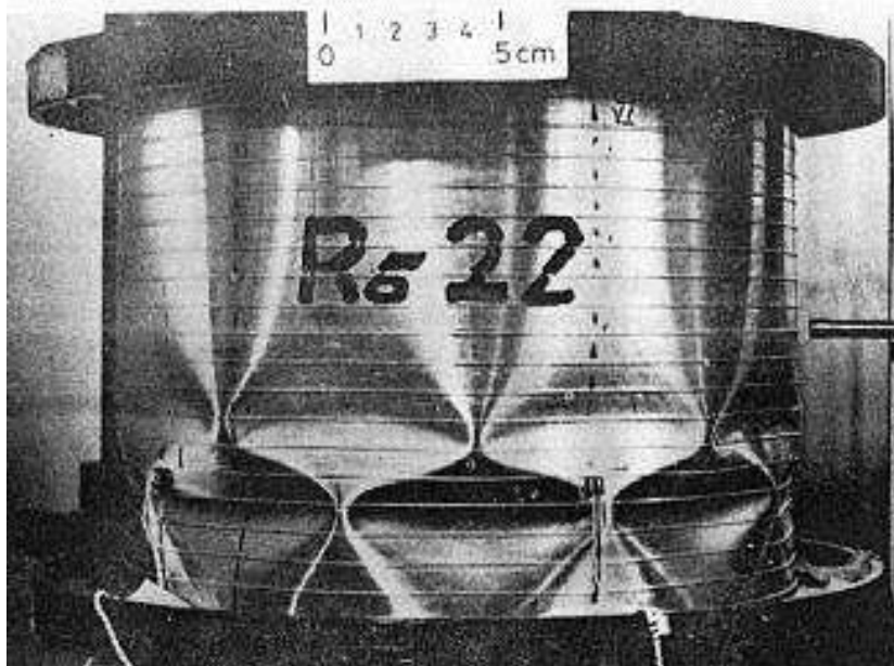
Obrázek 4: Zdeformovaná skořepina po ztrátě stability
