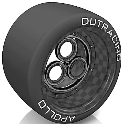
Obr. 6 Model uchycení převodovky v ráfku zdroj: http://fsteamdelft.nl
