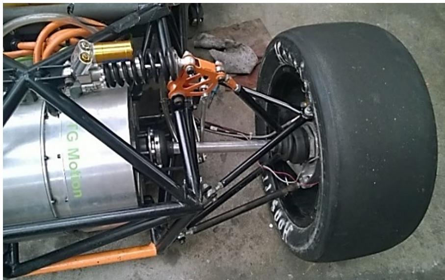
Obr. 1 Vůz FSE.02 týmu eForce FEE Prague Formula v roce 2013 Přímý pohon elektromotorem, bez převodu
