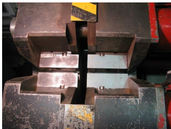
Obrázek 3.: Detail čelistí v lisovacích kleštích
