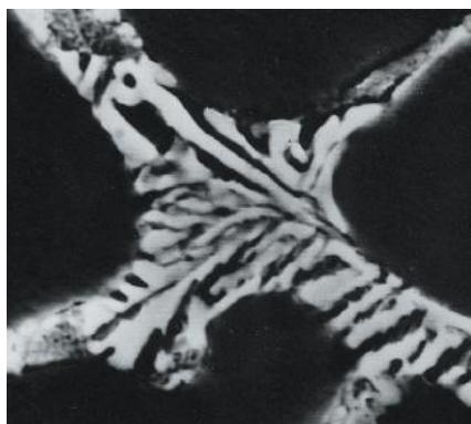
Obr. 2.4 a) Eutektikum slitiny EN AW-2024, zv. 1000x [2],
