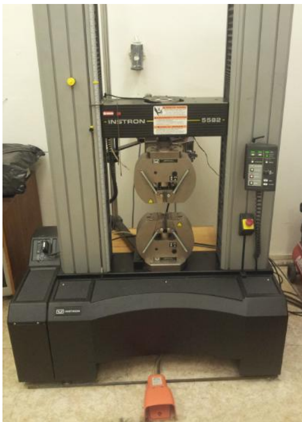
Obr. 3.3 Univerzální trhací stroj INSTRON 5582 s nosností rámu 100 kN [24]
