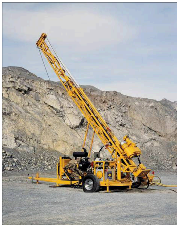
Obrázek 2.3: Přívěsná vrtná souprava [ru.mining-comp.com]
