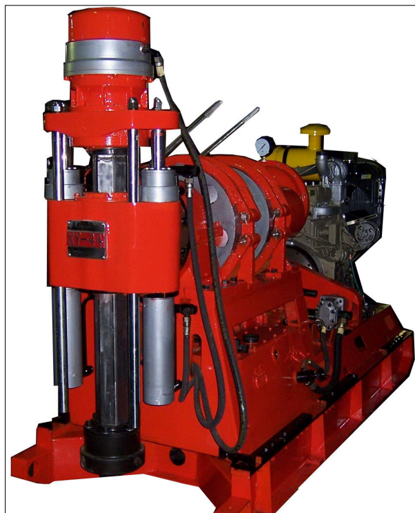
Obrázek 2.2: Stabilní vrtná souprava [www.anchordrillingrig.com]
