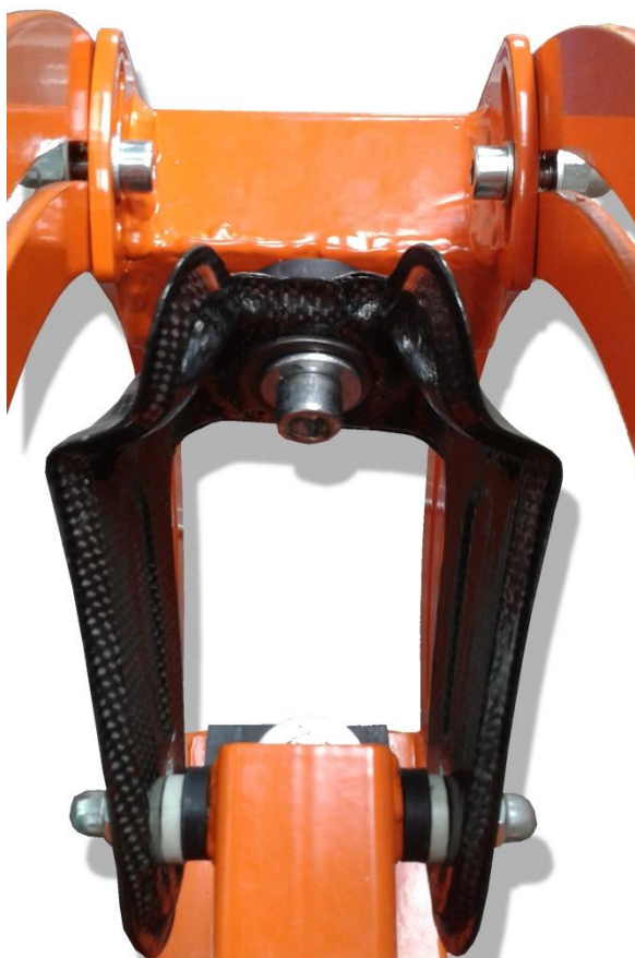
Obr. 53.: Destrukce kompozitní vidlice – poloha č.5.
