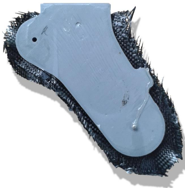
Obr. 39. : Vytvrzená konstrukce vidlice po odstranění svěrek.
