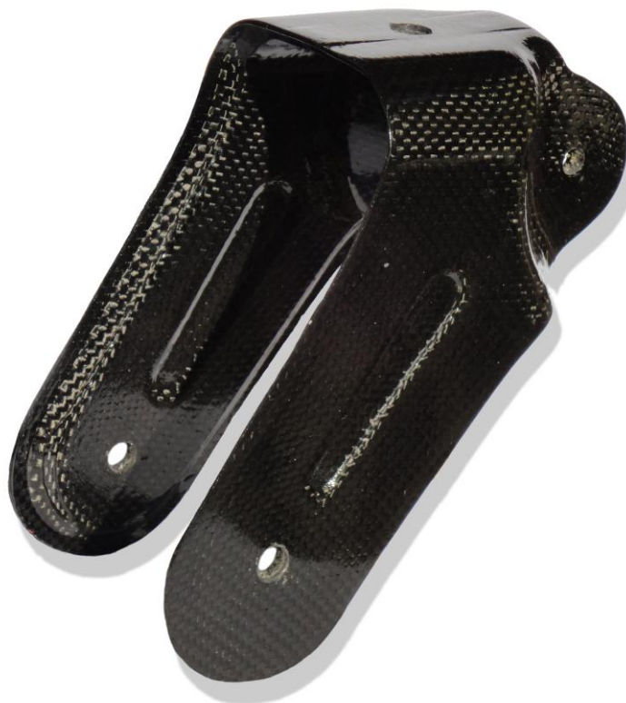
Obr. 40. : Kompozitní vidlice po opracování ostrých hran.
