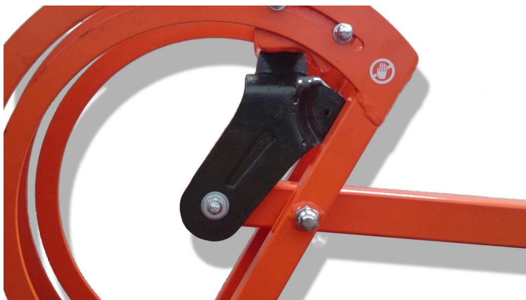
Obr. 48.: Zatížení vidlice – poloha č.1.
