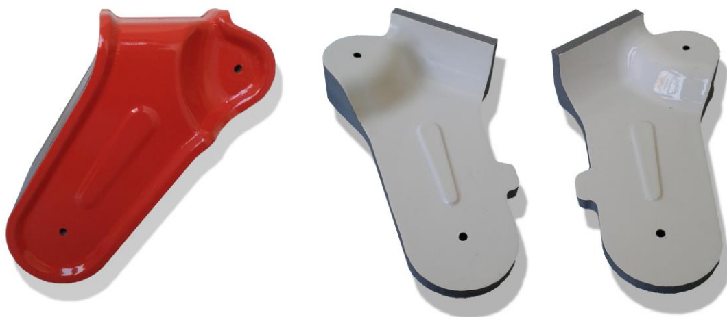
Obr. 38.: Forma potažená PVC fólií (červená – vnitřní plochy, bílá – vnější plochy).
